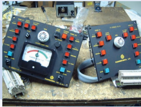
Панель аварийной сигнализации для управления из ходовой рубки и машинного отделения.
