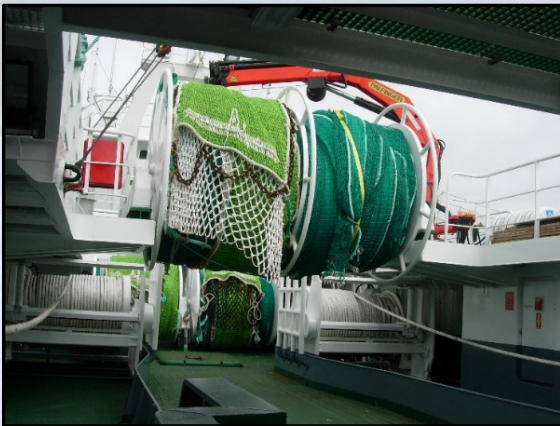
Установка на палубе барабанов для сети и лебедок для трала
