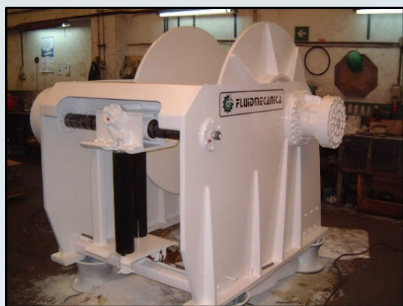
Гидравлическая тяговая лебедка для трала
