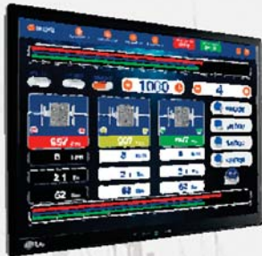
1 сенсорный экран интерфейса «пользователь – машина» (ЧМИ): 15" TFT 65536 цветов
