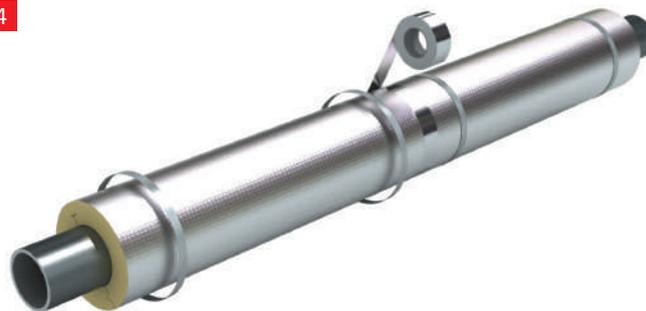
После установки цилиндров или сегментов их необходимо стянуть при помощи хомутов из металлической проволоки, оцинкованной проволоки, стальной или пластиковой ленты. Шаг крепления для проволоки – не более 300 мм, а для ленты – 600 мм. Проволока фиксируется скруткой, а лента – бандажными пряжками.
