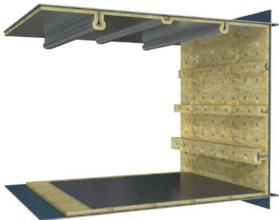
Плиты с покрытием могут быть хорошим законченным изоляционным решением для огнезащиты палуб, например, в машинном отделении (где нет высоких требований к облицовочному материалу). Материалы с покрытием обеспечивают чистую поверхность, не требующую больших усилий при техническом обслуживании. В качестве покрытия могут применяться стеклохолст и армированная алюминиевая фольга.
