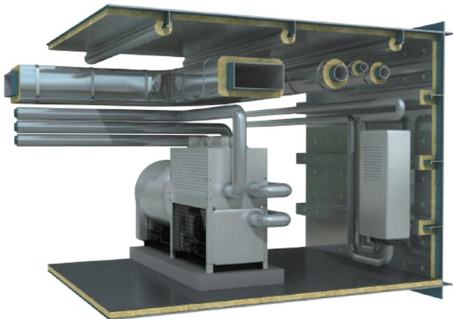
Негорючие цилиндры ТЕХНО Судовая – оптимальное решение для изоляции трубной части корабля за счет низкого веса и противопожарных характеристик.
